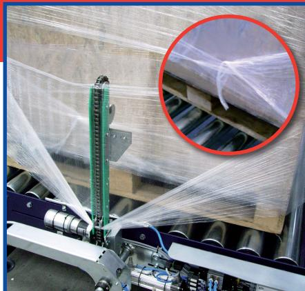
**IT** Sistema pinza taglio del film estensibile con inserimento del lembo finale nell'ultimo avvolgimento di film. Utilizzabile anche con film macroforato.
